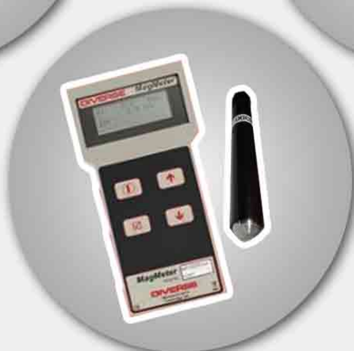
เครื่องตรวจสอบ ปริมาณเฟอร์ไรต์ Ferrite Meter
